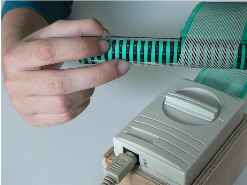
Abbildung 4.8: 3 Finger Präzisionsgriff am Greifstab. Zu sehen ist, dass die Positionen der Finger nicht in einer Orthogonalebene zum Stabzentrum liegen.
