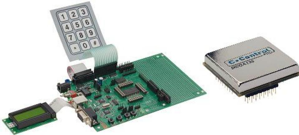
Abbildung 3.3: Mikrocontroller ATmega128 + Entwicklungsboard
